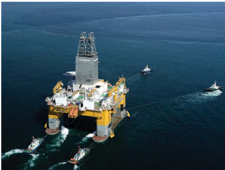
En Norsk eid «Semi rigg» borefartøy med NOV leveranser.
