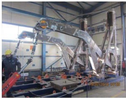
Livbåter er jo livreddende utstyr og derfor er kravene til sveis og konstruksjon svært strenge. Daviter samt løfte og utløser mekanismen gjennomgår streng kontroll. Her fra en test på Davit for livbåt i testbenken i Hellas.
